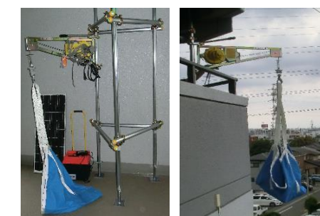
（簡易組立てクレーン）
